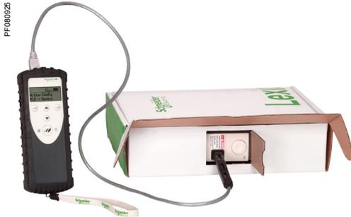
Configuration d'un Lexium 32 dans son emballage avec l'outil "Multi-Loader" VW3A8121 + un cordon VW3A8126
